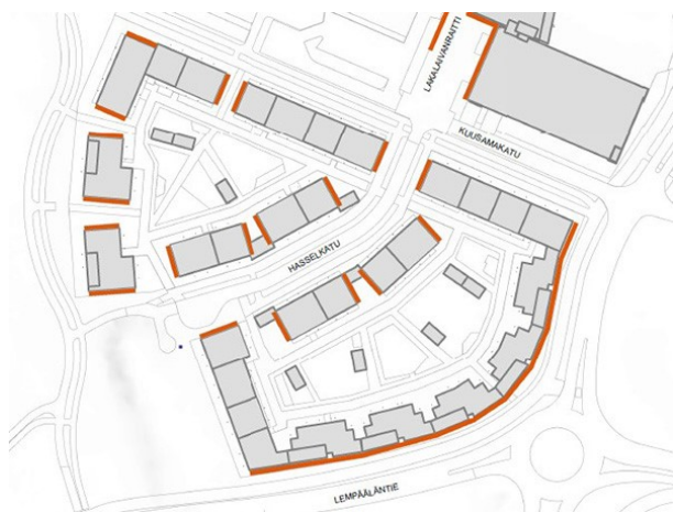
Kuva. Muurattavat julkisivut
